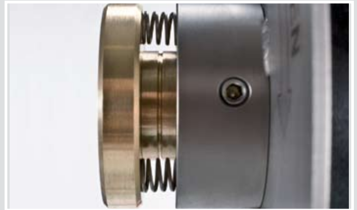
Инновационное устройство для постоянного натяжения ленты в течении всего процесса сварки.
