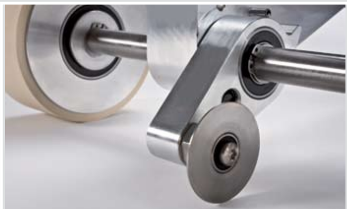
Направляющий ролик ведёт TAPEMAT в правильном положении сварки.
