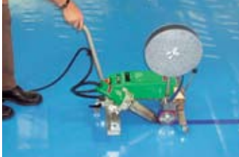
Автомат УНИМАТ для сварки лентой при наварке упрочняющей ленты 40 мм на ПВХ-ткань.
